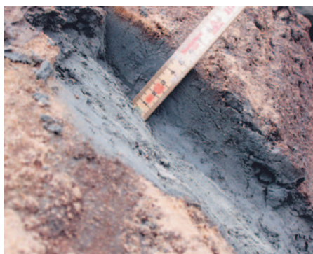
Bild 7: I det leriga skiktet mellan tre till sju meters djup konstaterades att brottet gick i genomsnitt 5 cm utanför pålens radie. Detta tyder på försumbar effekt av eventuell svaghetszon mellan påle och jord.
