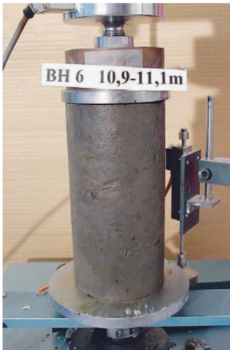
Bild 13: Enaxiella tryckförsök utförda på SGI i Linköping.
